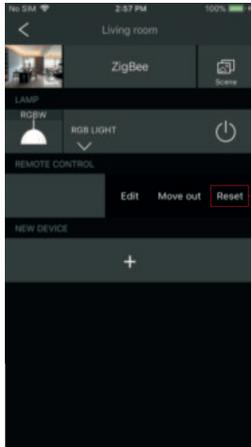
Wählen Sie beim Zigbee Controller oder Hub das Löschen oder Resetten der Bedienung wie angegeben, Indikator blinkt dreimal bei erfolgreichem Löschen.
